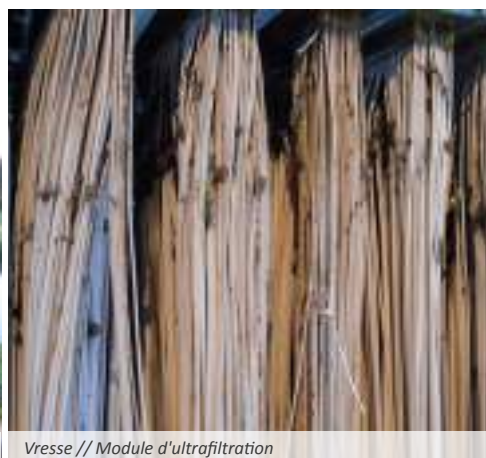
Vresse // Module d'ultrafiltration
