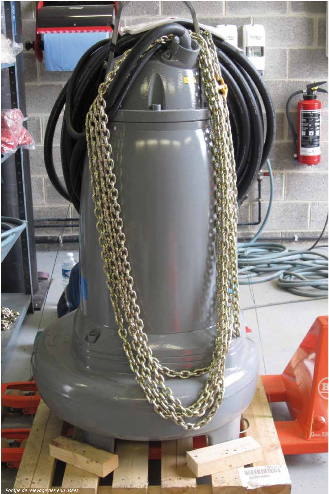
Pompe de relevage des eau usées
