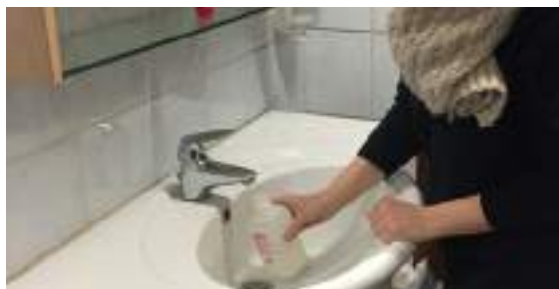
Prélèvement bactériologique pour le contrôle du réseau de distribution d'eau potable
