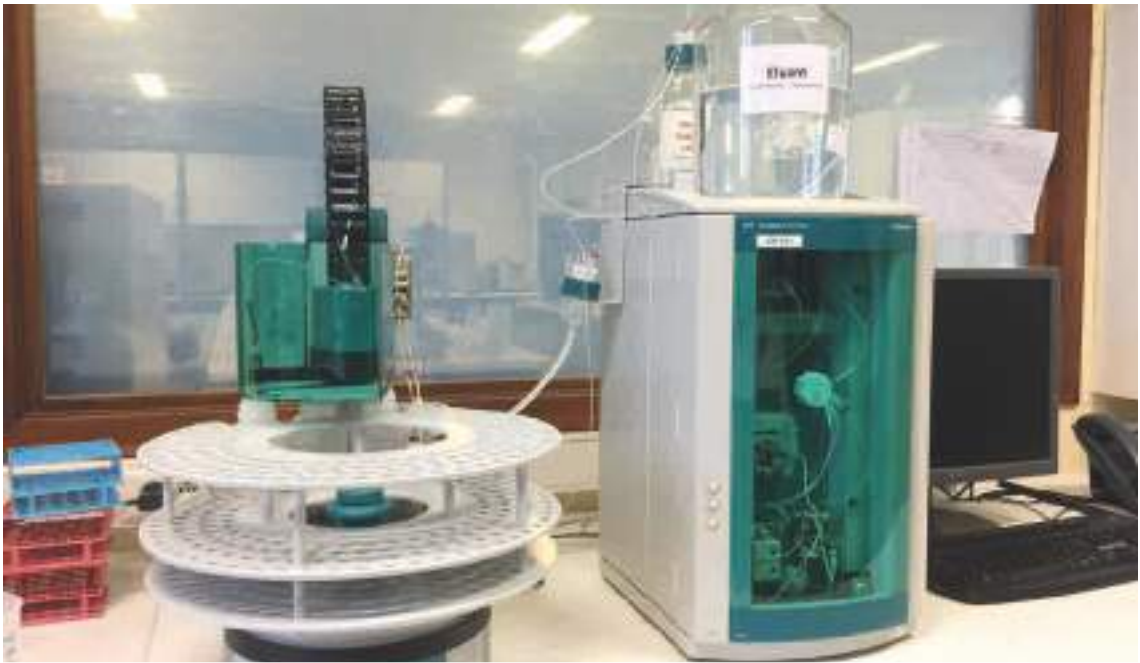
Appareil pour les analyses des anions par chromatographie ionique
