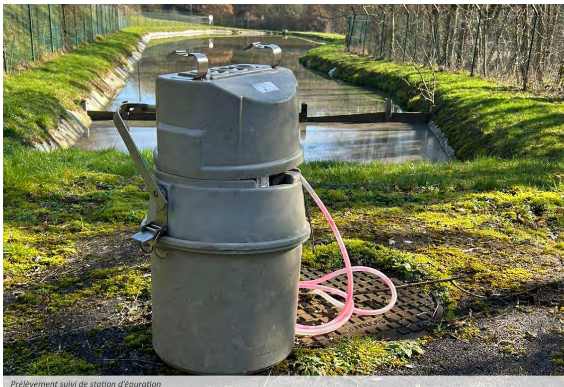
Prélèvement suivi de station d'épuration
