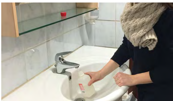
Prélèvement bactériologique pour le contrôle du réseau de distribution d'eau potable
