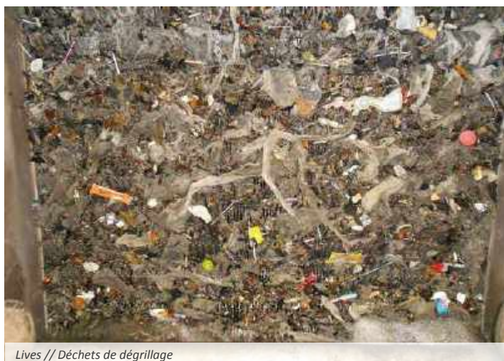
Lives // Déchets de dégrillage
